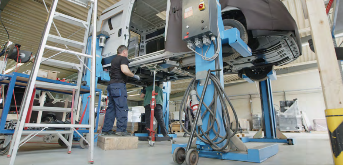
BILD OBEN LINKS Anbau Trittstufe und Vorbereitung der Unterflurelemente
