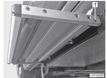
Fig. 87 End stop (entrance step)
